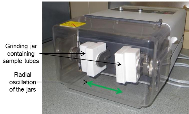
**Fig. IV/4. Mixer mill (model MM301, Retsch)**
