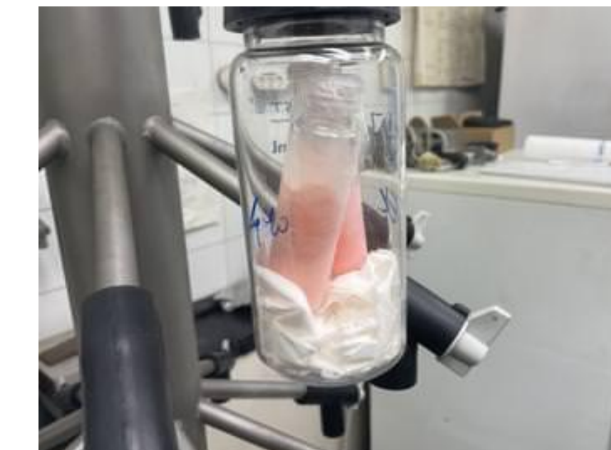
a daunomicin-peptid konjugátum izolálása liofilizálással
