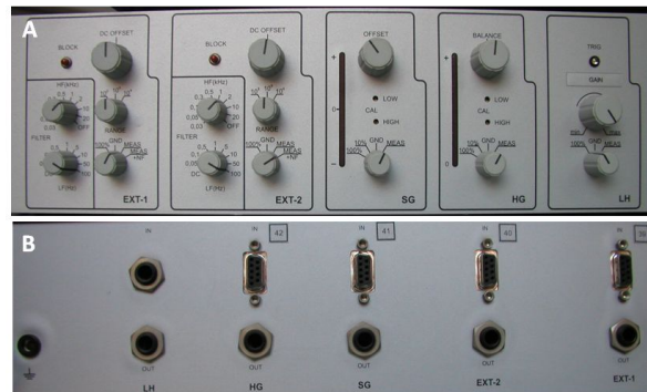
2.6. ábra. A gyakorlaton használt kombinált erősítő előlapja (A) és hátlapja (B). Az előlapon a kezelőgombok használata a szövegben részletesen olvasható. A hátlapon csatlakoztatjuk a szenzorokat a megfelelő bemenetbe (IN), az átalakított jelet pedig a kimeneti csatlakozóval (OUT) kötjük a gyűjtődobozhoz.
