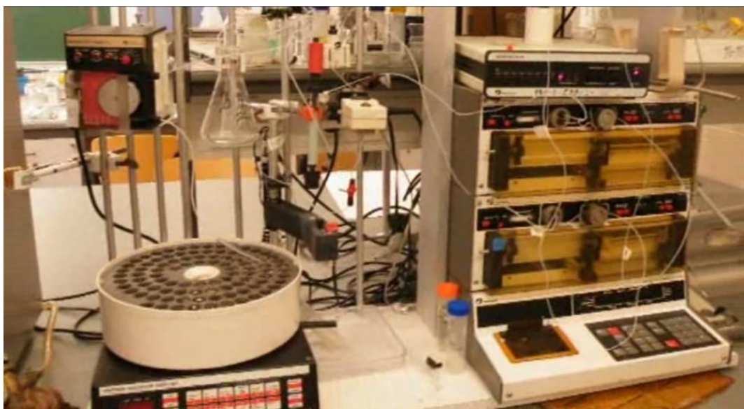
12.1. video: Fúziós rekombináns fehérje tisztítása affinitás kromatográfiával (FPLC)
