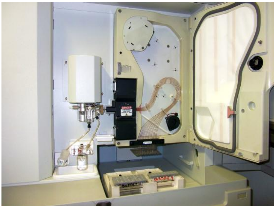
5.3. ábra: Egy automata fluoreszcens DNS szekvenátor (a Biomi Kft.-nek köszönjük a fotót)
