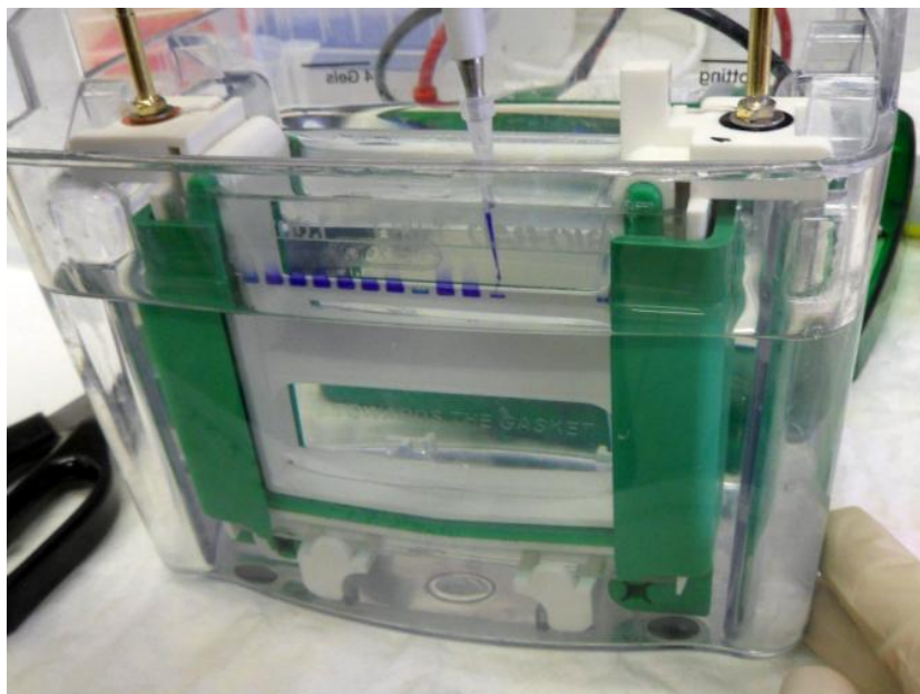
4.6. ábra: Poliakrilamid gélelektroforézis készülék „kamráinak” felöltése mintákkal.
