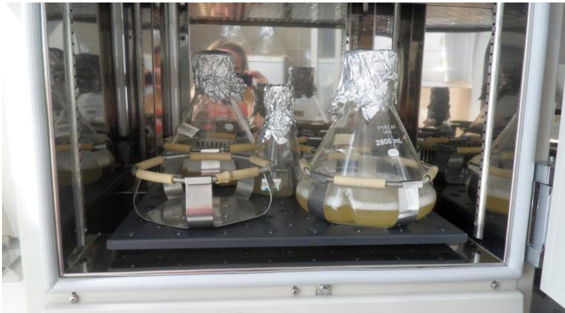
12.8. ábra: Rázató inkubátor prokarióta és eukarióta szuszpenziós kultúrához
