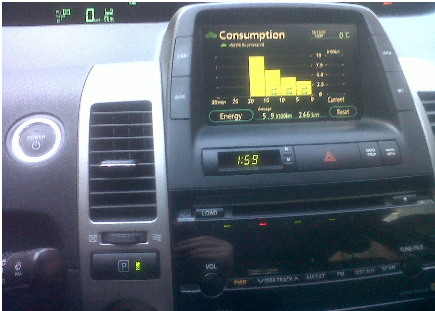
58. ábra. A hibrid üzemű Toyota Prius műszerfalán a főképernyőn kérhet tájékoztatást a gépjárművezető az elmúlt fél óra fogyasztási adatairól, 5 perces bontásban (Fotó: Munkácsy B.)
