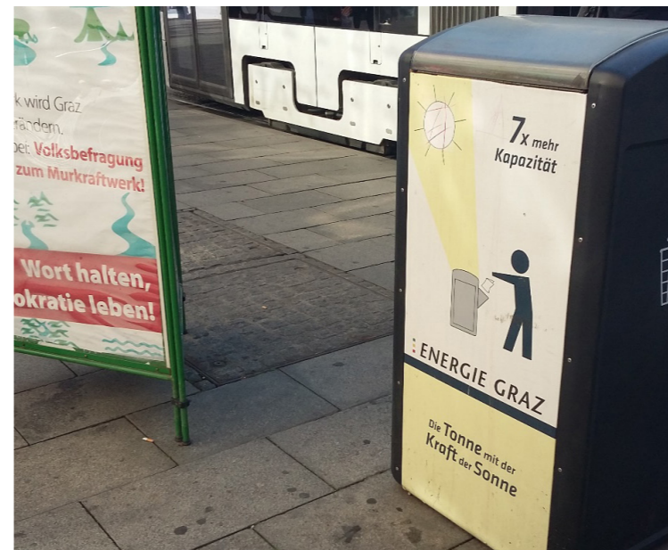
28. ábra. Napelemes energiaellátással működő prérészterekkel ellátott utcai hulladékgyűjtő Grazban (Fotó: Munkácsy B. 2016)
