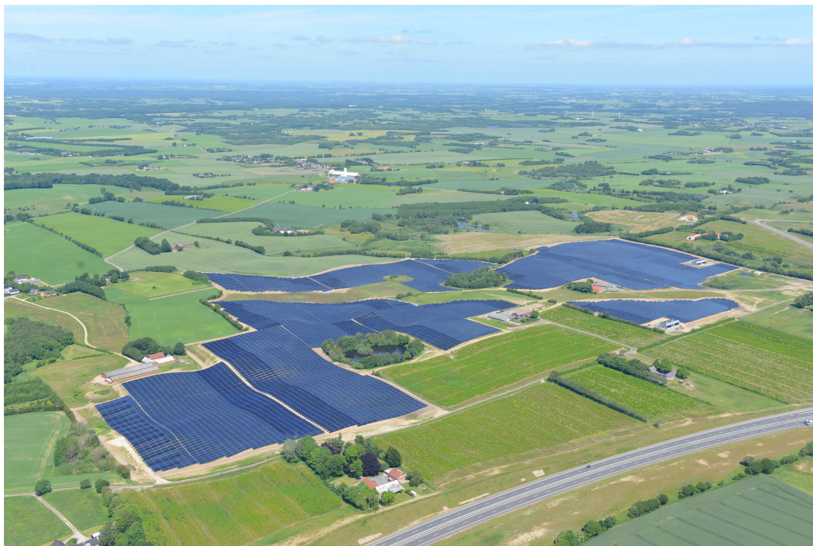
81. ábra. A világ legnagyobb napkollektoros távfűtési rendszere a dániai Silkeborgban ( http://dk.arcon-sunmark.com )
