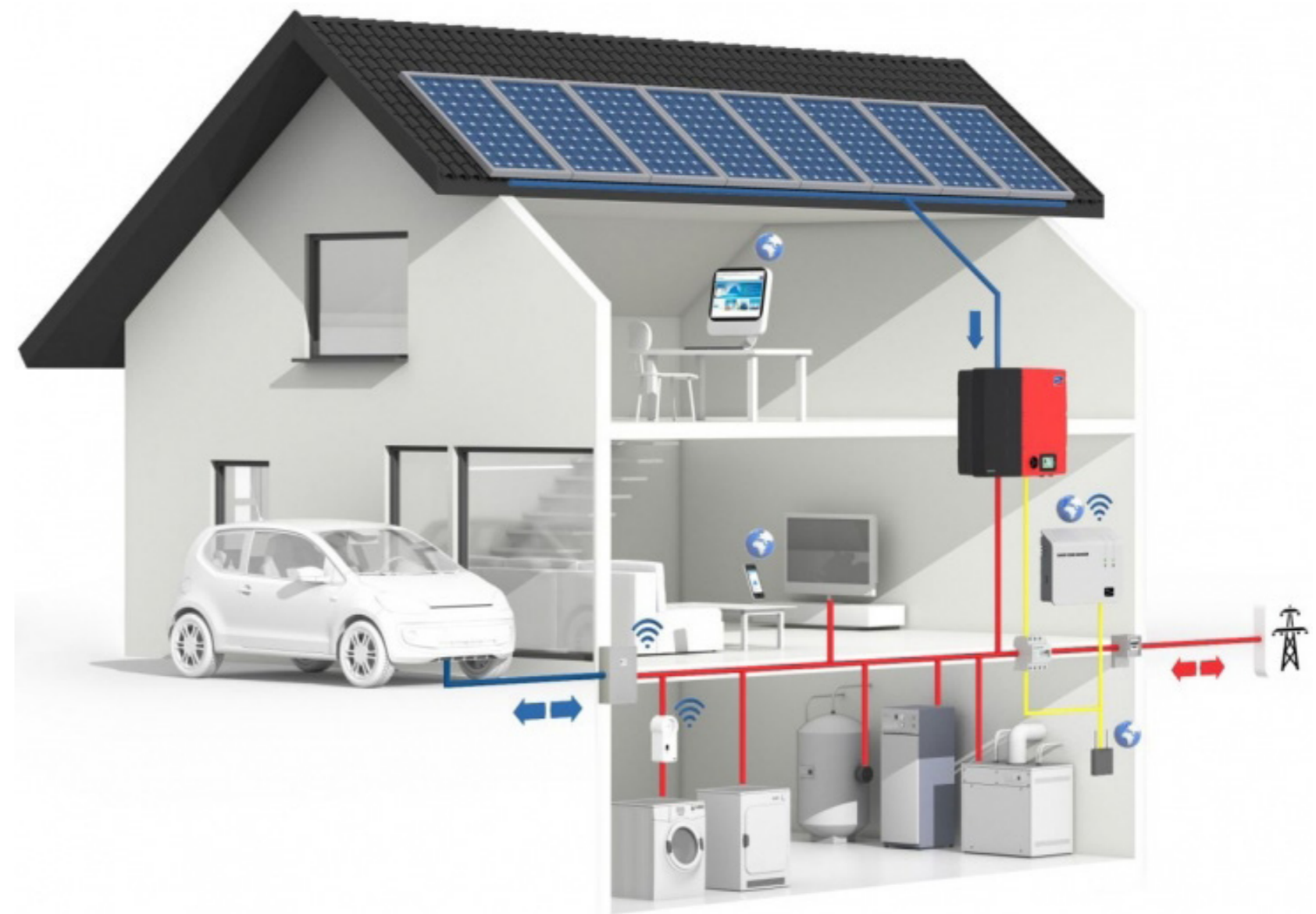
155. ábra. Az elektromos autó integrálásának lehetősége energiátárolóként a háztartási villamosenergia-rendszerbe
