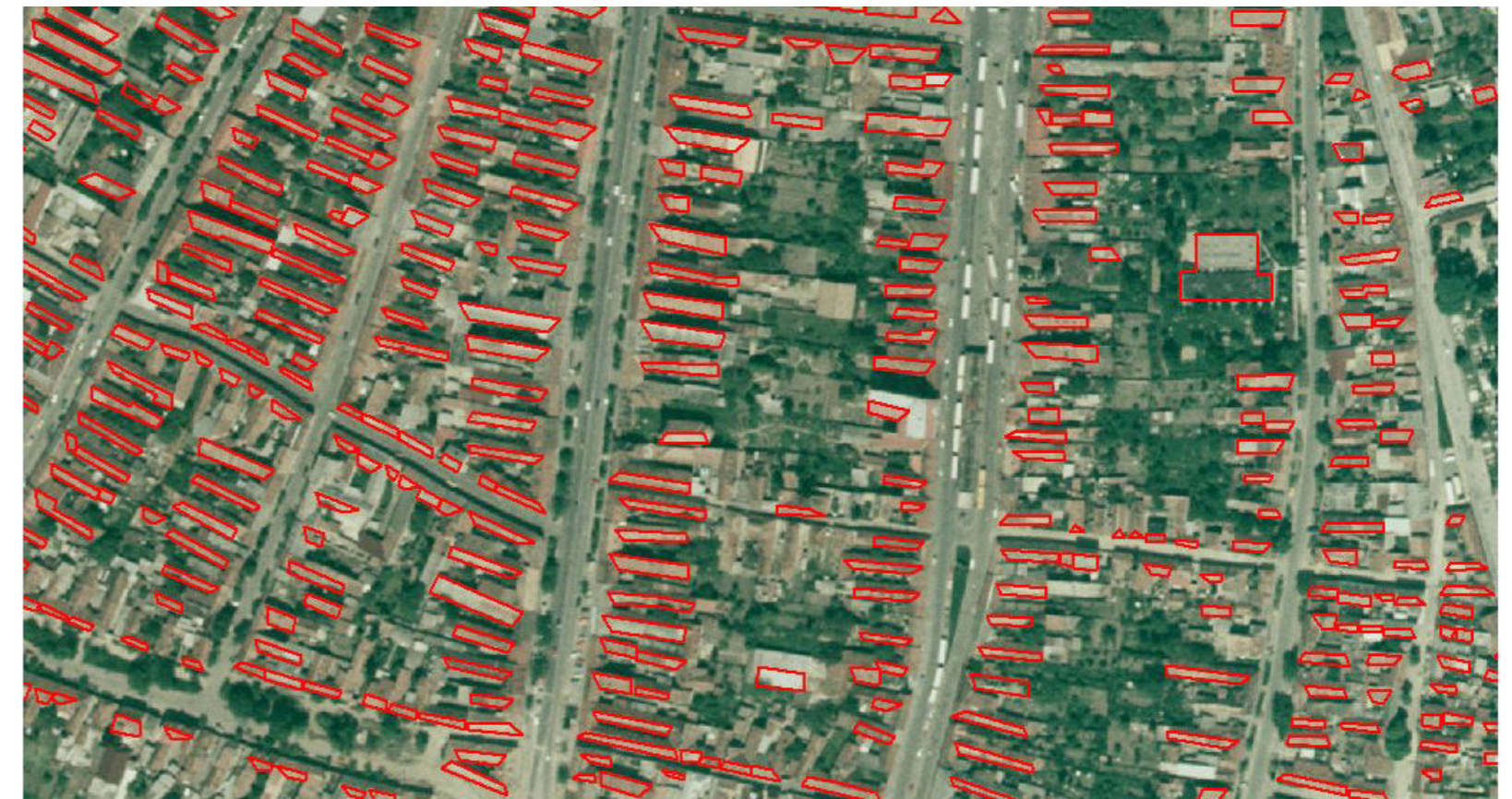
137. ábra. Ortofotó-alapú térinformatikai elemzés, amely Esztergom belvárosában mutatja az aktív napenergia-hasznosítás szempontjából alkalmasnak ítélt, délies tájolású tetőfelületeket (Munkácsy B. et al. 2008)
