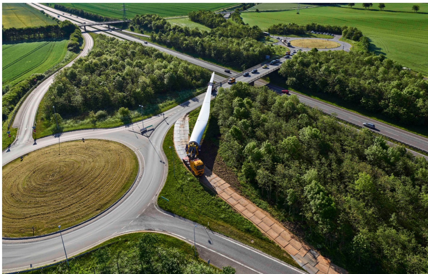
152. ábra. A turbinalapátok nemcsak a felhasznált erőforrások szempontjából, de a szállítás nehézségei miatt is kulcsfontosságú elemei a szélerőműveknek ( http://inhabitat.com/ )
