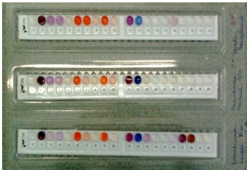
72. ábra API ZYM teszt eredménye különböző baktériumtörzseken 6 órás 37 °C-on történő inkubációt követően (Fotó: Tóth E.)
