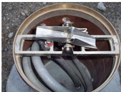
3.4. ábra. Billenőedényes csapadékmérő belseje (nem az automatában alkalmazott változat)
