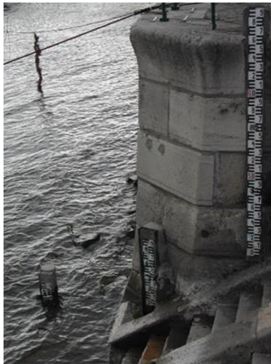
3.17. ábra. Álló vízmérce (Duna – Budapest, Nemzetközi hajóállomás)
