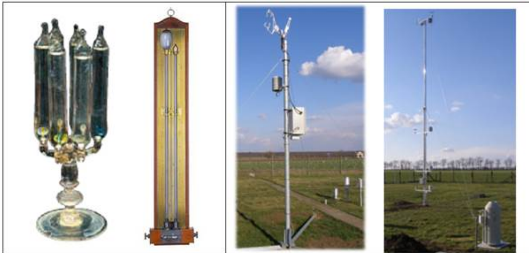
I.1. ábra. Korabeli termoszkóp és barométer az Accademia del Cimento műszereiből a XVII. század második feléből (bal oldal). A debreceni alapéghajlati mérőállomás két meteorológiai mérőtornya (jobb oldal) rajta az árnyékolóval ellátott Väisälä hőmérséklet-nedvesség mérők (jobb szélén) illetve a szélsébség és a hőmérsékletfluktuációk (10 Hz) meghatározására szolgáló CSAT3 szonikus anemométer és a H 2 O/CO 2 mérésére szolgáló LiCor 7500 szenzor (középső ábra) (Nagy Z, OMSZ felvétele).
