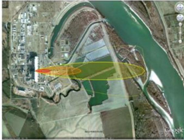
VII.4. ábra. Az ALOHA alkalmazása: egy feltételezett baleset során 100 kg ammóniát bocsátottunk ki egy perc alatt a Paksi Atomerőmű bejáratához vezető útszakaszon. Az egyes színek az ammóniára vonatkozó különböző határérték túllépéseket jelentik.
