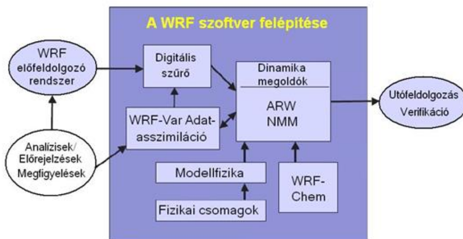
I.24. ábra. A WRF3 felépítése és adatáramlási rendszere. ARW – Advanced Research WRF kutatási célú WRF modell, NMM – Nonhydrostatic Mesoscale Model nem-hidrostatikus mezoskálájú modell, a WRF operatív célokra fejlesztett változata.
