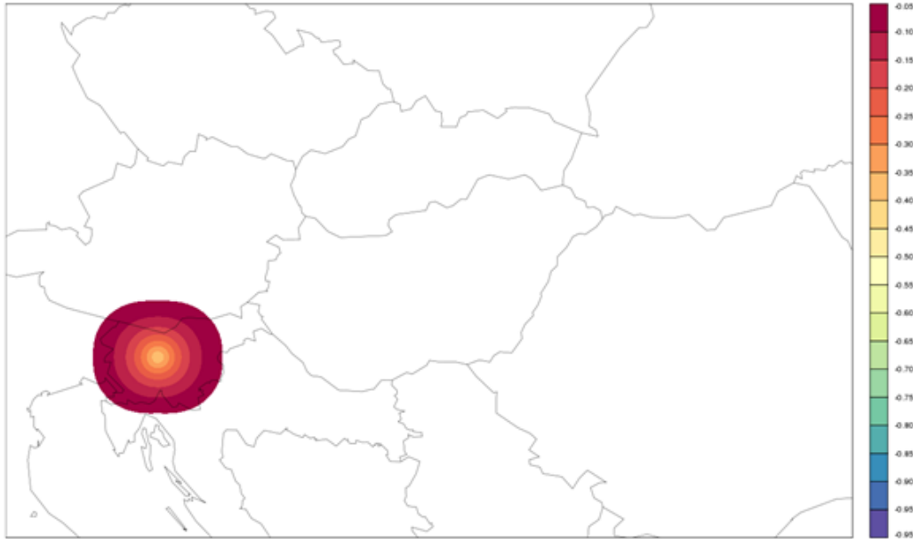
II.8. ábra. Az analízis és a háttérmező különbsége (analízis inkrementum) a hőmérsékletre (K) a kb. 500 hPa-os szinten egy megfigyelés felhasználásával, amely 1 K-nel tér el a háttértől a megfigyelési pontban. Az ábra jól érzékelteti, hogy a Ljubljana fölötti hőmérséklet megfigyelés hatása horizontálisan kiterjed az analízisben a B háttér hiba kovariancia mátrix hatására. A kísérlet az AROME nem hidrosztatikus modellel készült 2,5 km-es horizontális ráctávolságot használva.
