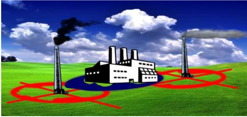
VIII.5. ábra. Sematikus ábra a magas pontforrások és az épületek által keltett turbulencia hatására kialakult együttes szennyezetségi mező szemléltetésére (kékkel jelölt terület).
