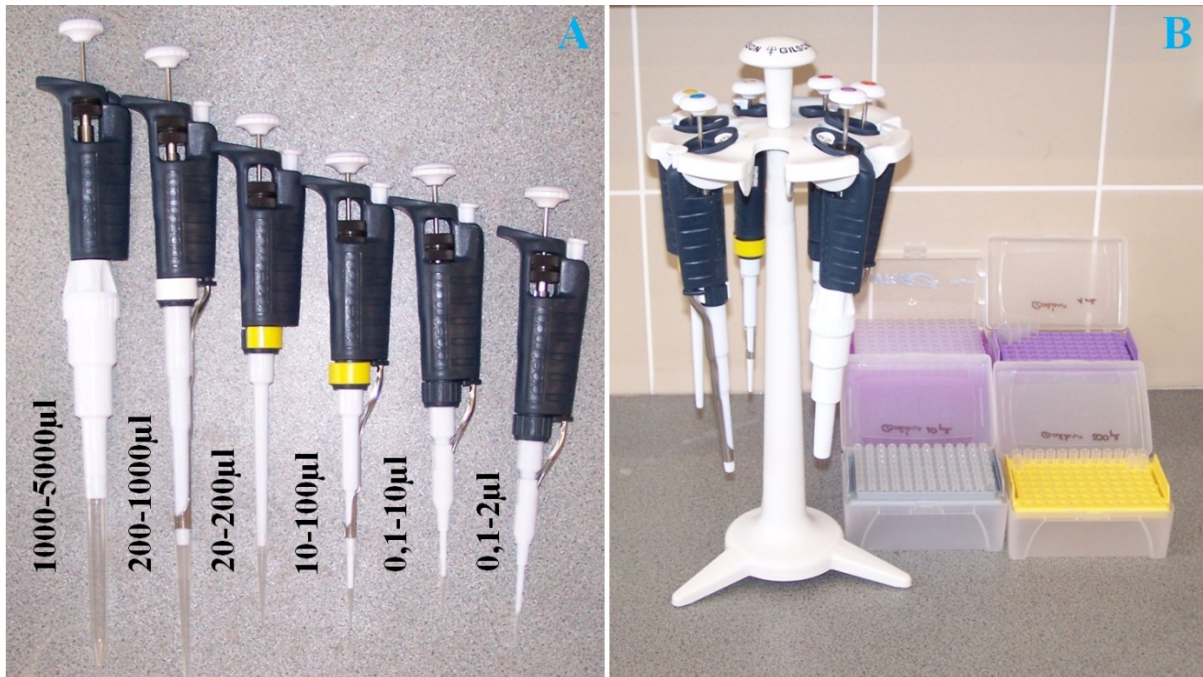
1.7. ábra. A: Automata pipetták és méréstartományuk. B: Pipetták a pipettaállványon és különböző pipettahegyek pipettahegy-tartó dobozokban.
