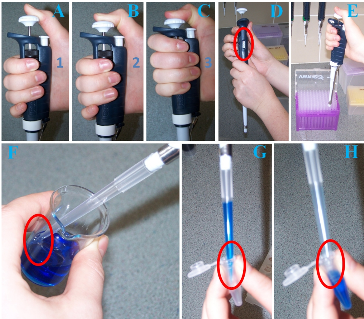
1.9. ábra. A-B: A pipetta dugattyújának három állása; D-H: A pipettázás folyamata (D: térfogat beállítása, E: pipettahegy rögzítése, F: a folyadék felszívása, G: a hegy áthelyezése egy új csőbe, H: a folyadék leeresztése).
