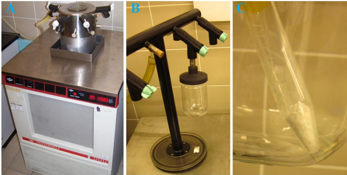
1.20. ábra. A: Liofilizátor, tetején a vákuum kamrával; B: A vákuum kamra csövek segítségével kiterjeszthető, így több minta egyidejű kezelése is lehetséges; C: Liofilizálódó minta a vákuum kamrában, egy Falcon-cső belsejében.
