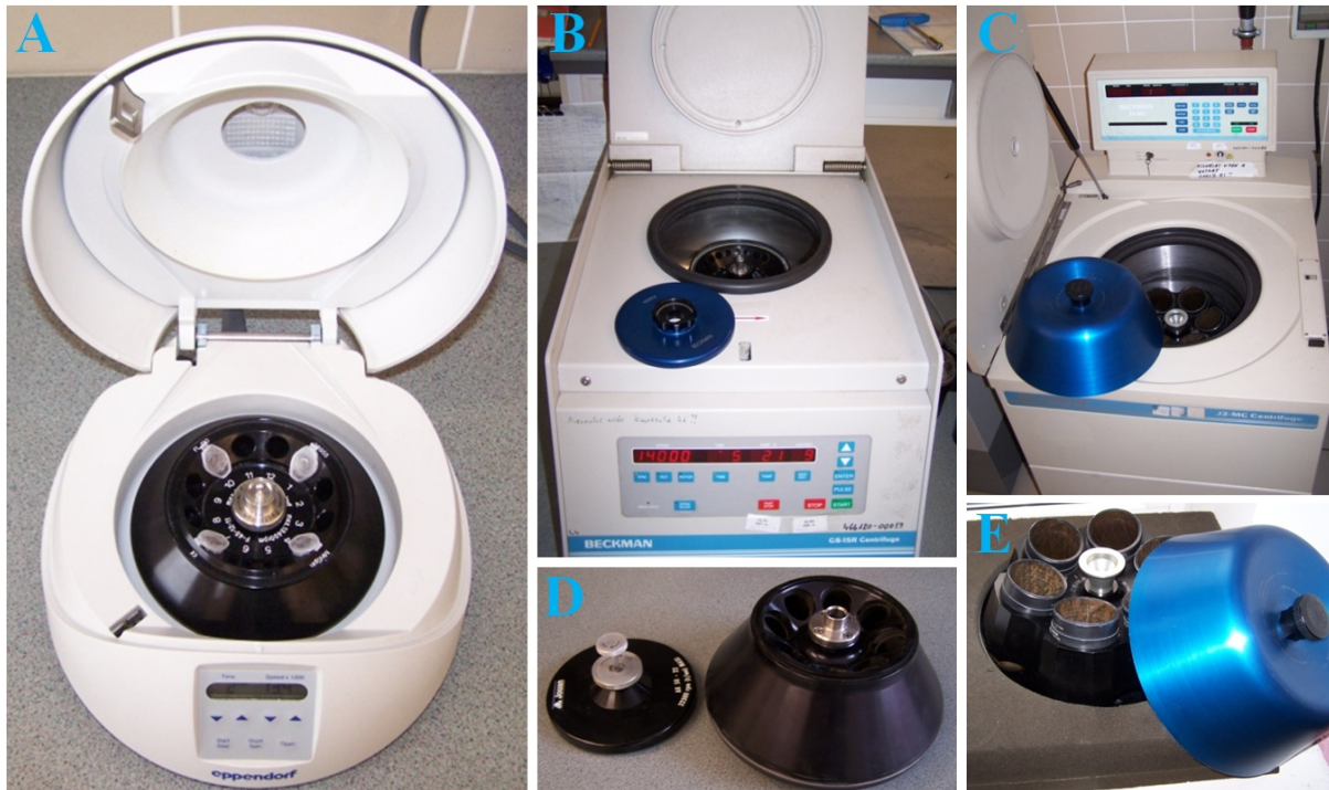
1.15. ábra. A: Asztali Eppendorf-centrifuga a rotorban szimmetrikusan elhelyezett Eppendorf csövekkel (maximális fordulatszám: 14 000/perc); B: Szemipreparatív, hűthető centrifuga, Eppendorf rotorral; C: Preparatív centrifuga és rotorja, mely több liter folyadék egyszerre történő centrifugálására képes; D: Szemipreparatív rotor és fedele; E: Preparatív rotor és fedele.
