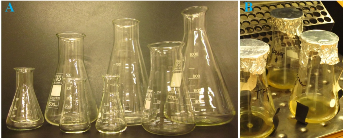
1.5. ábra. A: Különböző méretű Erlenmeyer lombikok; B: Erlenmeyer lombikok használata E. coli sejtek tenyésztésére.
