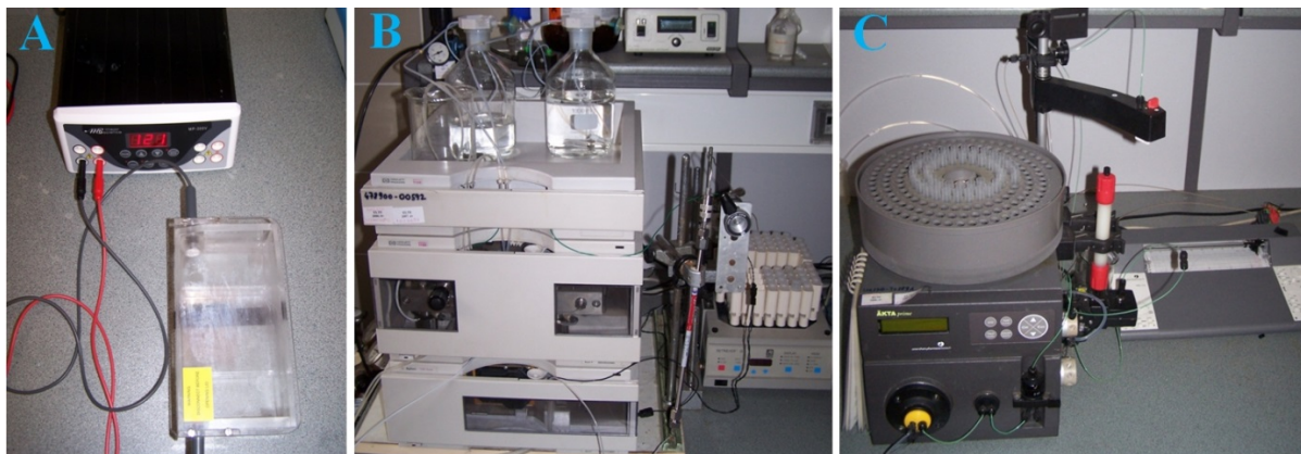
1.19. ábra. A: Gélelektroforézishez használt tápegység és a hozzá csatlakoztatott puffertartály (a puffertartályban található a gél, melyben az elválasztás zajlik); B: Kromatográfiai munkaállomás (HPLC: High-Performance Liquid Chromatography , azaz nagy teljesítményű folyadékkromatográfia) C: Kromatográfiai munkaállomás (FPLC: Fast Protein Liquid Chromatography ).
