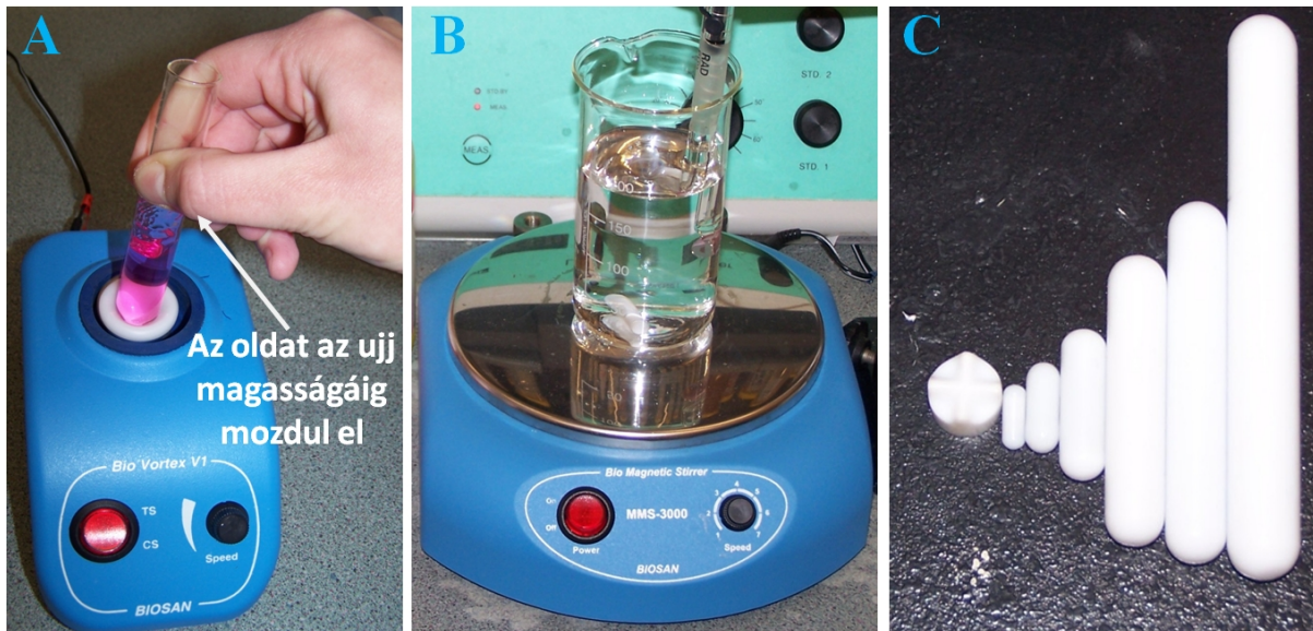
1.10. ábra. A: Folyadék keverése Vortex keverővel; B: Folyadék keverése pH mérés közben, mágneses keverő segítségével (a folyadékba fentről belemerül a pH mérő berendezés kombinált üvegelektrodja); C: Különböző méretű és alakú, teflonnal bevont, mágneses keverőbabák.
