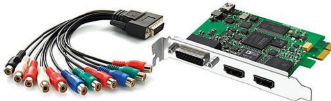
6.18 ábra Egy korszerű editáló kártya és csatlakozói.
