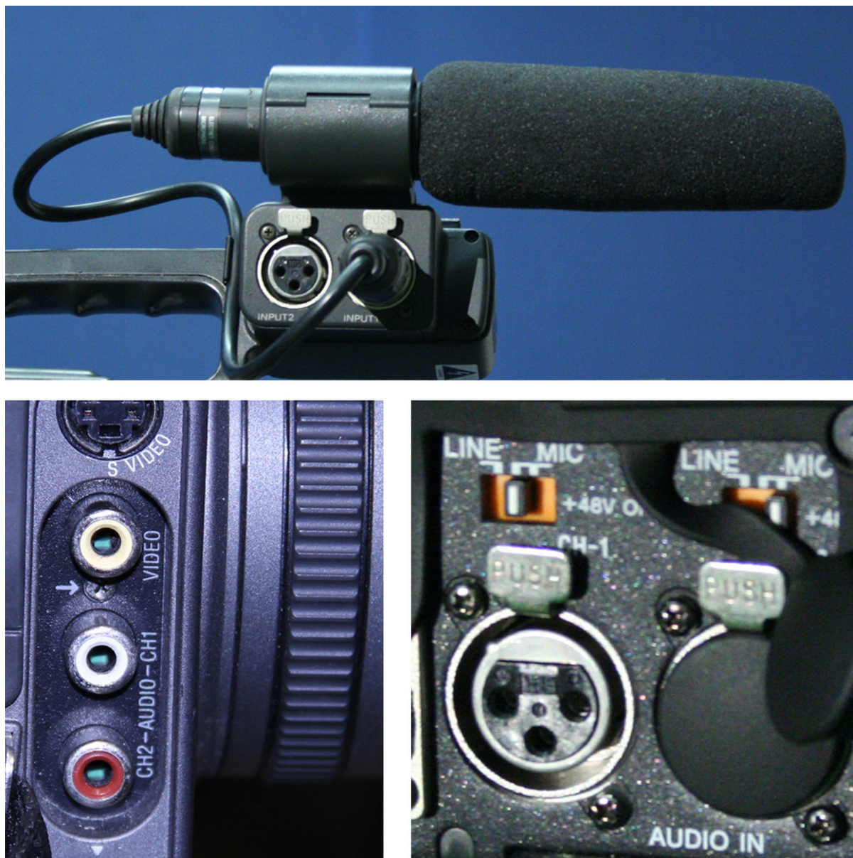
2.10. ábra Digitális kamerák hangcsatlakozói
