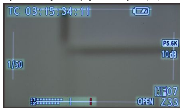
9.7 ábra Beállítások kijelzése a keresőben Alternatív szöveg: Az operatőr számára a kamera keresőjében megjeleníthető információk elhelyezkedését mutatja az ábra. Timecode, akkumulátor állapot, expozíciós idő, színhőmérséklet, erősítés, élességállítási mód, rekesznyílás, zoom állapot.
