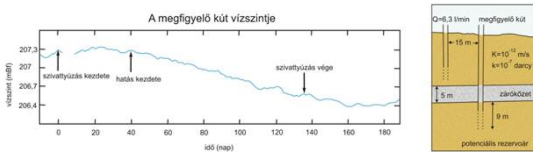
10.8. ábra: Észlelt vízszintváltozások egy vékony „zárókőzet” feletti vízadóban, a vízrekesztő alatti vízadó szivattyúzása során (Witherspoon és Neuman, 1967 nyomán)
