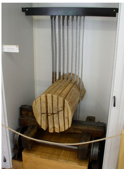
7.9. kép: A félig felfűrészelt rönkfa minden szövegnél egyszerűbben magyarázza ennek a fűrésznek a működését. (Fotó: Vásárhelyi Tamás)
