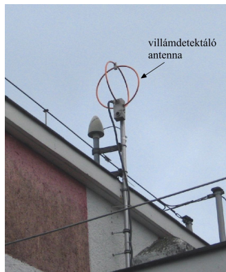
10.7. ábra: A LINET (Lightning Detection Network) villámdetektáló antennája az Országos Meteorológiai szolgálat szegedi meteorológiai állomásán
