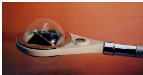
4.28. ábra: Middleton CN1-R típusú nettó pirradiométer (sugárzási egyenleg mérő). A felfelé és lefelé néző érzékelőket egy műszerben helyezik el és a két felfogó test hőmérséklet-különbségéből származtatják a kimenő jelet. Az érzékelőket lupolen búra védi.
