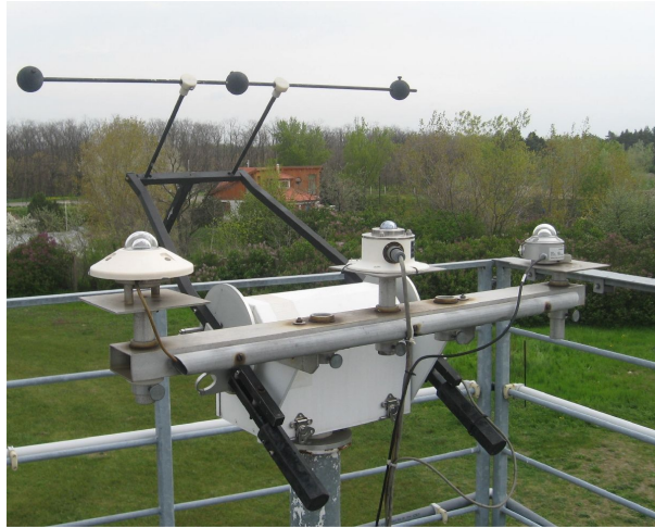
4.27. ábra: Diffúz (szórt) sugárzás mérése különböző piranométerekkel az Országos Meteorológiai Szolgálat Pestszentlőrinci Főobszervatóriumában. A Nap térszögéből érkező direkt (közvetlen) sugárzást egy a Nap égi járását követő szerkezet takarja ki az érzékelő elől, ezért arra csak szórt sugárzás jut.
