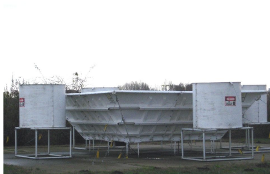
9.12. ábra: Az Országos Meteorológiai Szolgálat szegedi meteorológiai állomásán található Waisala Lap 3000 típusú RASS (Rádió-akusztikus szondázó rendszer)
