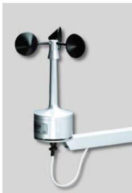
4.5. ábra: Vaisala típusú forgókanalas szélmérő. A szélkanalak tengelyének forgása által keltett elektromos impulzusokból határozható meg a szél sebessége.
