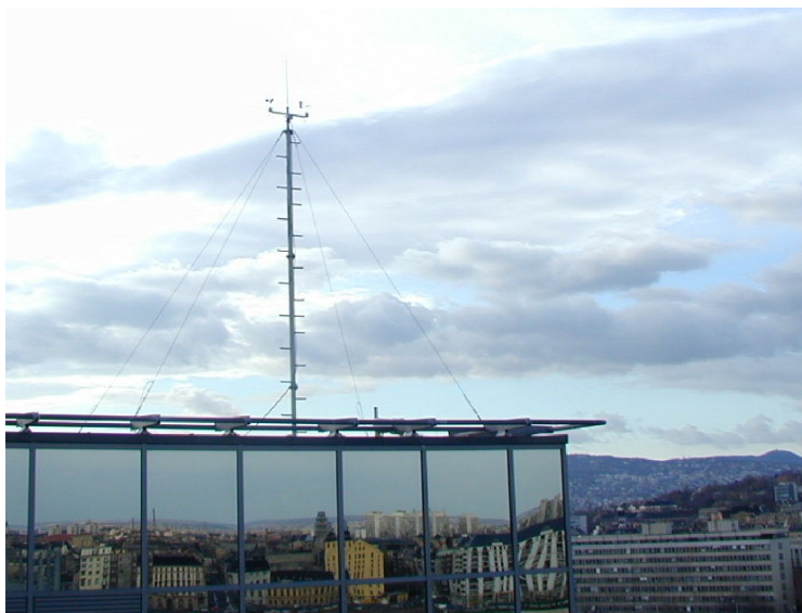
4.8. ábra: A szélirány és szélsébségmérő az Eötvös Loránd Tudományegyetem lágymányosi épületének tetején, városi környezetben
