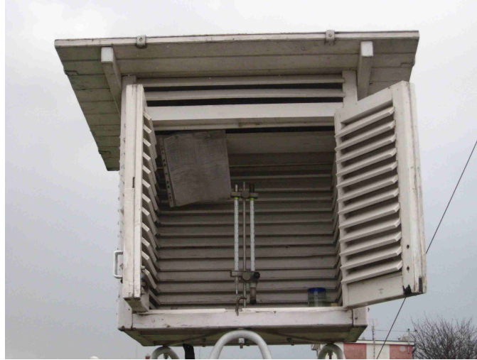
3.10. ábra: Stevenson-féle hőmérőház. A hőmérőket fehérre festett, dupla zsaluzású házikóban helyezik el a felszín felett 2m magasságban. Az árnyékolás a Nap közvetlen sugarainak hatását gátolja, a zsaluzott falak az erős szél hatását redukálják, a légmozgást azonban biztosítják.
