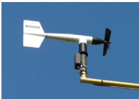
4.6. ábra: Young típusú propelleres szélmérő. Pontos mérés végezhető vele, de szélirányfüggő, ezért a szélzászlóval egybeépítve alkalmazható meteorológiai célokra.
