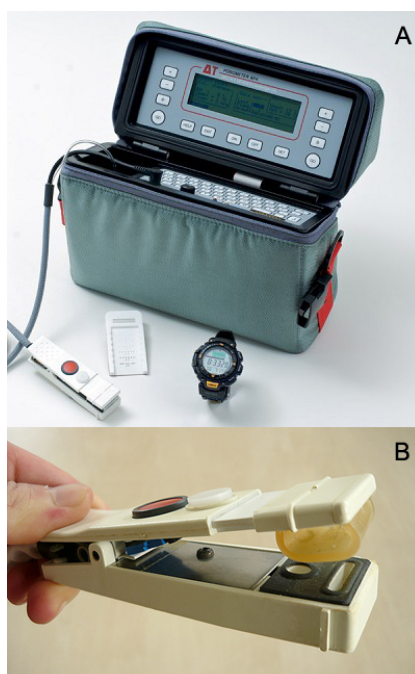
2.1. ábra AP4 porométer és tartozékai(a Delta-T Devices Ltd. engedélyével) (A) és a mérőfej nyitott állásban (B)
