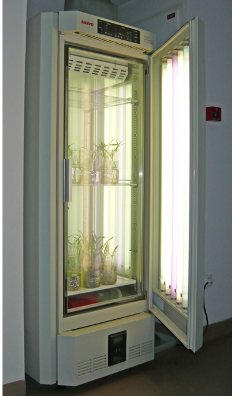
1.1. ábra Kísérleti növények klímakontrollált nevelésére szolgáló, kis méretű, fitotron kamra
