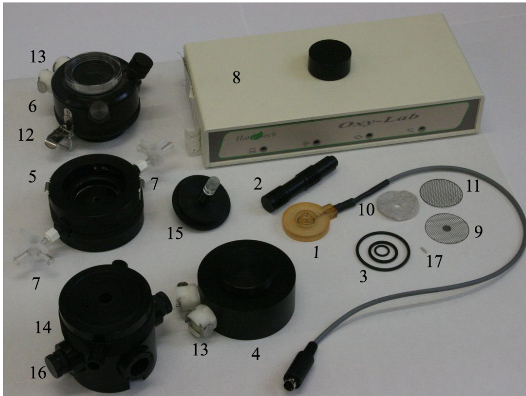
6.1. ábra. A Hansatech-típusú O 2 -elektrod részerei. A számozott részek leírását lásd a szövegben.
