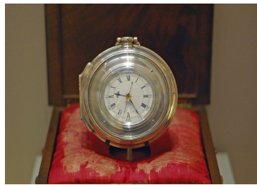
1.17. ábra. John Harrison H5 hajózási kronométere (Forrás: http://upload.wikimedia.org/wikipedia/commons/1/14/Harrison%27s_Chronometer_H5.JPG )
