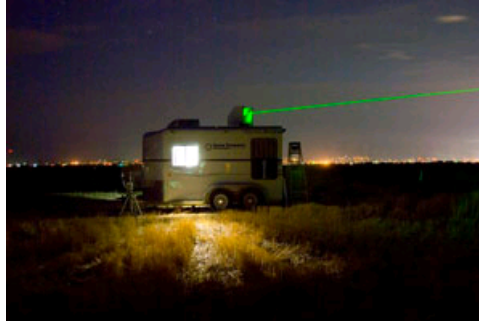
4.10. ábra. Differenciális elnyelésű LIDAR működés közben (Forrás: http://energydynamicslab.com/company/images/aglite-lidar.jpg )
