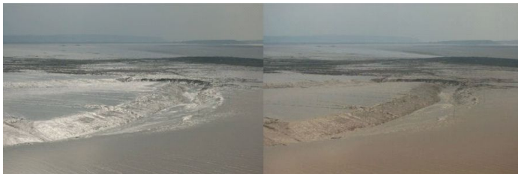
Tengerpart és iszapzátony képe polarizált fényben. Bal oldalt: a visszavert napsugárzást maximáló polarizátor, jobb oldalt: a szórt sugárzást maximáló polarizátor alkalmazásával.
