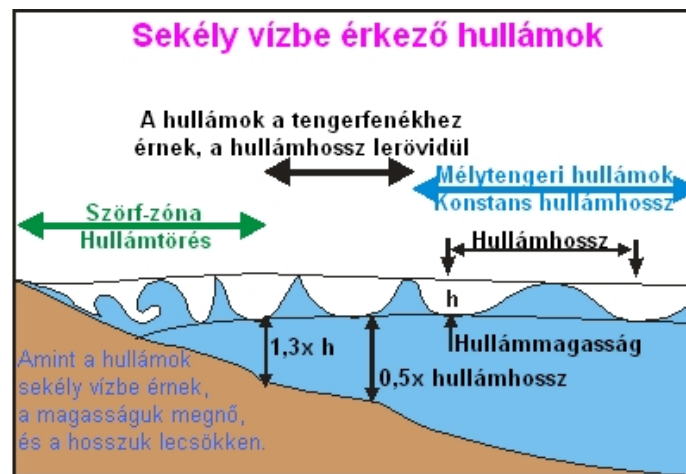
5.10. ábra. A mélytengeri hullámok magasságának alakulása sekély vízbe érésük után (Forrás: http://www.seafriends.org.nz/oceano/ocean05.gif )
