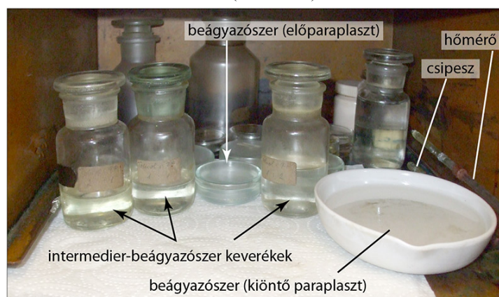
2.20. ábra. A beágyazáshoz termosztátban előkészített oldatok és eszközök
