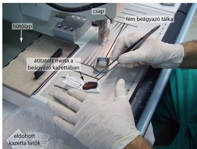
2.23. ábra. Beágyazógép munkapadja: a beágyazás kezdetén a fém beágyazótálka félig víztiszta beágyazószerrel töltött, s éppen a minta kazettából való kiemelését látjuk
