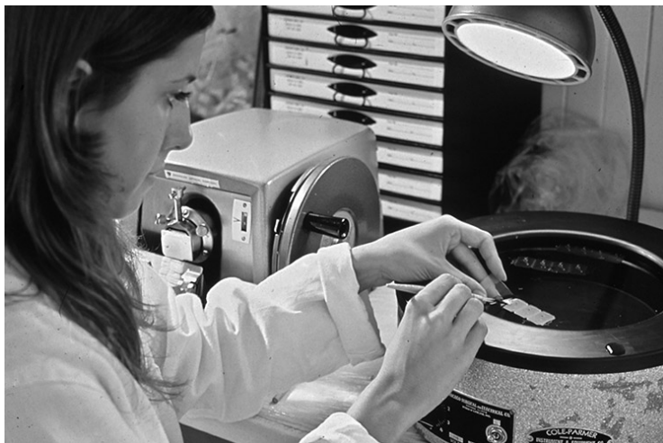
2.32. ábra. A sorozatmetszetek vízfürdő segítségével húzhatók fel egy tárgylemezre
