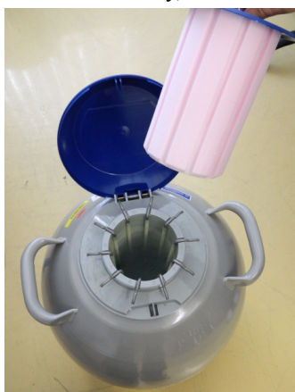
5.17. ábra. A lefedett Dewar-edény, oldalt két füllel a szállításhoz
