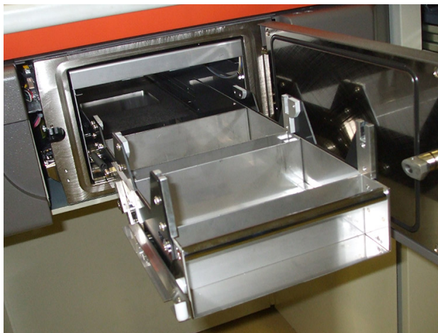
4.13. ábra. A síkfilmes negatívok számára kialakított kazetták helye a mikroszkóp lábázatában
