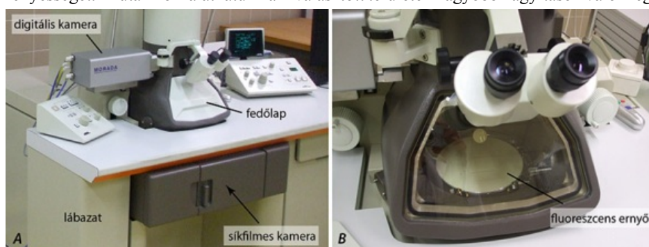
4.12. ábra. A megfigyelőkamra és a képrögzítő kamerák (A), a fluoreszcens ernyő az okulárokkal (B)
