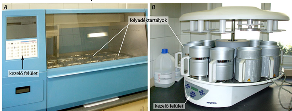
2.22. ábra. Víztelenítőautomaták: régebbi (A) és újabb (B) típus
