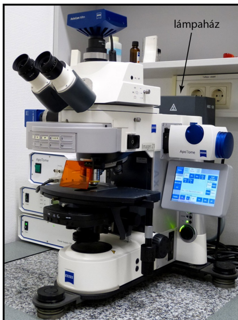
3.18. ábra. Korszerű epifluoreszcens mikroszkóp: a mikroszkóp mögött látható sötétszürke doboz a gerjesztő fényforrást rejtő lámpaház
