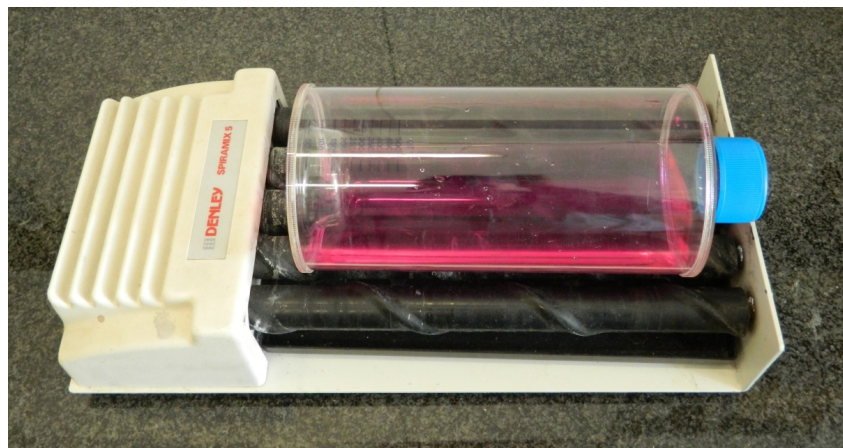
5.57. ábra. Monolayer tenyészetek forgópalackos rendszerben
