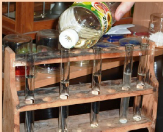
4. Desztillált víz + vasszög → bedugaszolni vattával + NaCl → lezárni gumidugóval
