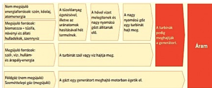
7.1. ábra. Az erőművi technológiák sematikus ábrája (forrás: Energiavilág. E.ON Hungaria és E.ON Földgáz Kommunikációs Osztálya)
