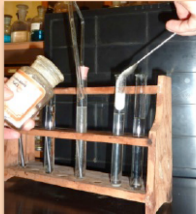
4. Desztillált víz + vasszög → bedugaszolni vattával + NaCl → lezárni gumidugóval
