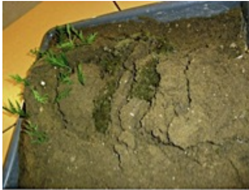
6.8. kép. A csuszamlás modellezése homoktálcán (fotó: Farkas B. P.2011)
