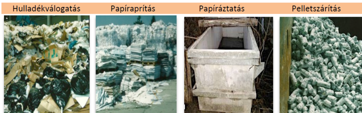
7.6. kép. A biobrickett előállításával kapcsolatos részfolyamatok (fotók: Makádi M. 2008)
