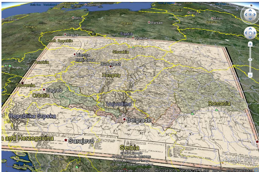
1. ábra. Goetz és Probst 1804-es Magyarország-térképe a Google Earth felületén: teljesen különböző technológiákkal készült adatok egységesítése a georeferencia által.
