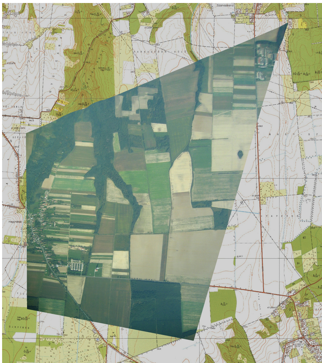
58. ábra. Az előző fénykép rektifikált változata topográfiai térképre illesztve. Az optikai tengely nagyon eltér a nadírtól: ezért a furcsa alak – viszont az illeszkedés a legtávolabbi részen is elfogadható.
