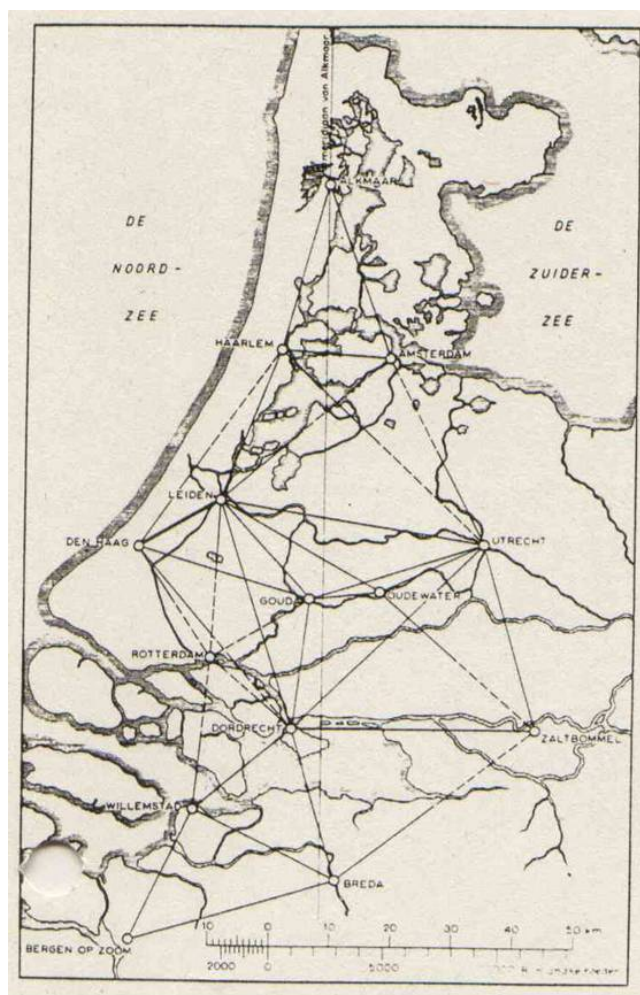
12. ábra. Snellius 1615-ös holland háromszögelésével állapították meg Alkmaar (északon) és Breda (délen) távolságát, mocsarakon és folyókon keresztül.
