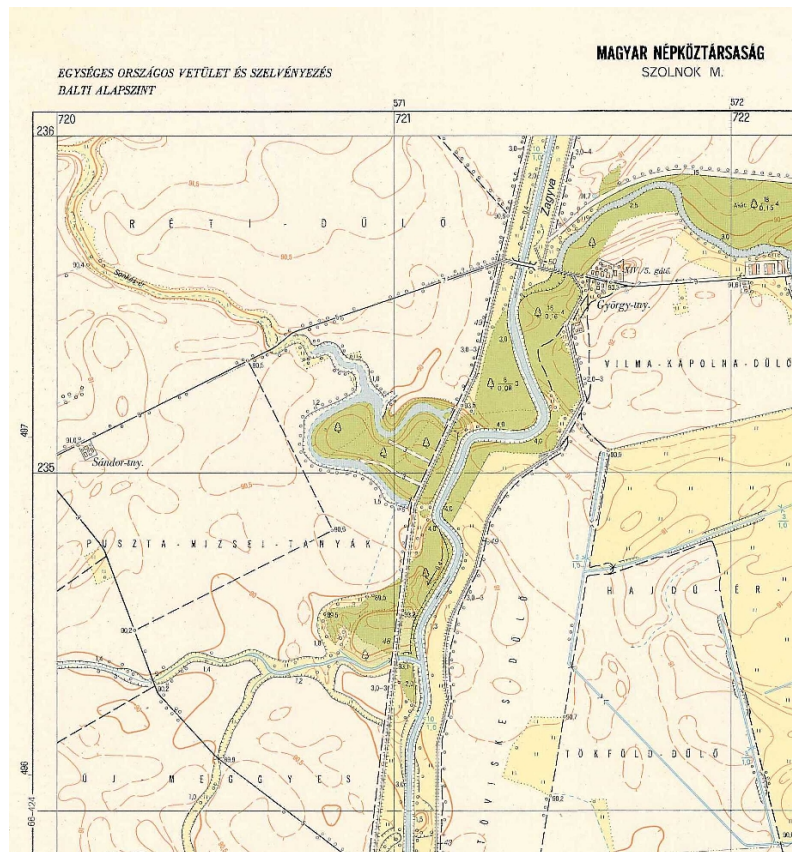
25. ábra. Az EOV-térképszelvényen nincsenek földrajzi koordináták feltüntetve; a térképszelvények határa a vetületi koordináta- vonalakat követi.
