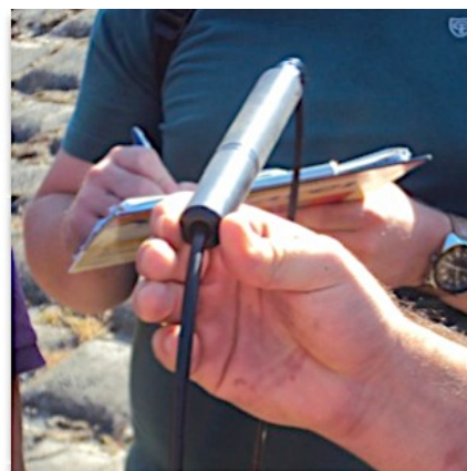
5.2. kép. Talajvízszintmérés mérőkútban és a talajvízhőmérő leolvasása (fotók: 2012)
