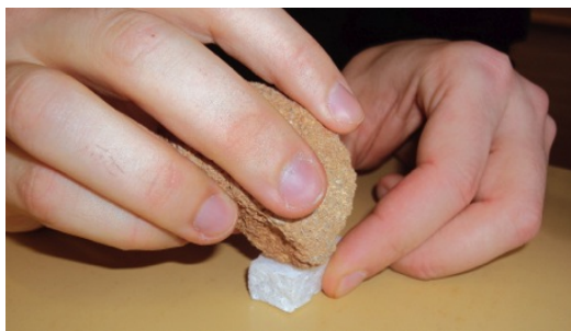
3.3. kép. Márvány karcolása kvarc-homokkővel (fotó: Makádi M. 2013)
