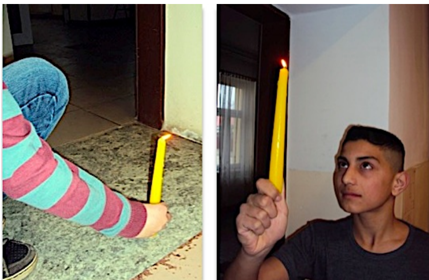
6.46. kép. Légáramlási rendszer modellezése gyertyalánggal – lángja alul befelé (balra), felül kifelé (jobbra) (fotók: Makádi M. 2013)
