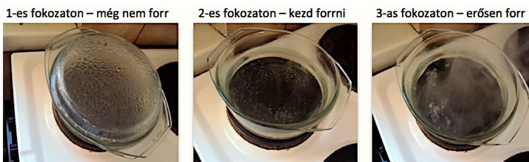
5.17. kép. A hőmérséklet víz körforgásának sebességét befolyásoló hatásának igazolása főzőlapon – 5 perc elteltével (fotók: Makádi M. 2013)
