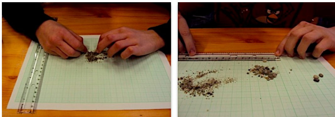
3.9. kép. Folyóvízi hordalékok szemcseméret szerinti szétválogatása (fotók: Makádi M. 2013)
