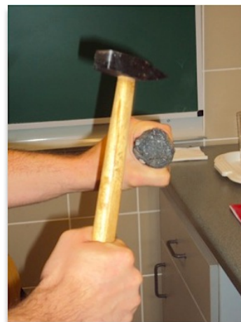
3.2. kép. Kőzet keménységének vizsgálata késsel (balra), reszelővel (középen) és kalapáccsal (jobbra) (fotók: Makádi M. 2013)
