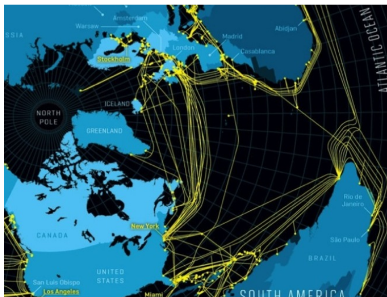
7.16. kép. Az internet tenger alatti optikai kábelhálózata Európa és Amerika között (forrás: http://visualizing.org/visualizations/map-internet-submarine-cables )
