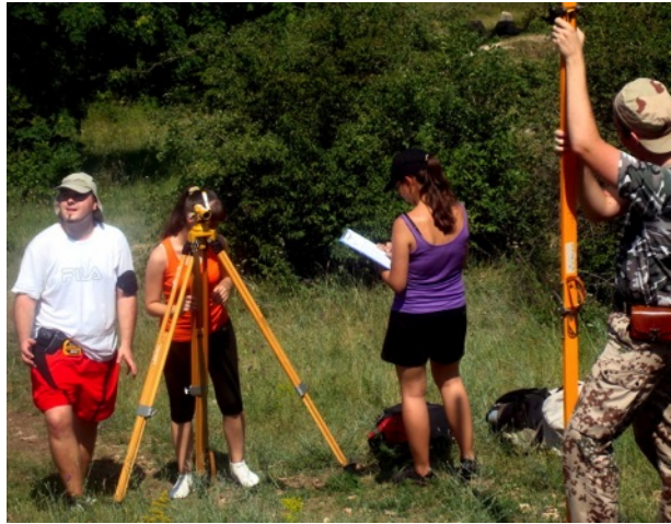
2.14. kép. A térképhelyesbítés egyetemi változata szintezéssel (fotó: Horváth G. 2012)
