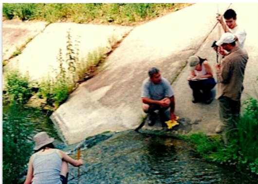
5.4. kép. Vízsebességmérés forgószárnyas sebességmérővel (fotó: Kovács P. 2007)
