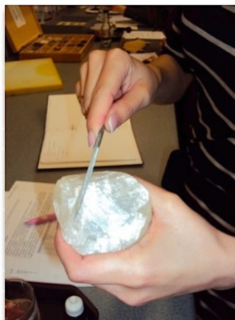
3.2. kép. Kőzet keménységének vizsgálata késsel (balra), reszelővel (középen) és kalapáccsal (jobbra) (fotók: Makádi M. 2013)
