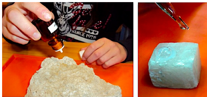
3.12. kép. Mésző- és kalcitvizsgálat savcseppentéssel (fotók: Makádi M. 2013)
