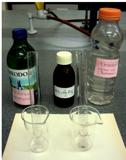
5.9. kép. Vízminta oldott kloridtartalmának kimutatása (fotó: Makádi M. 2013)
