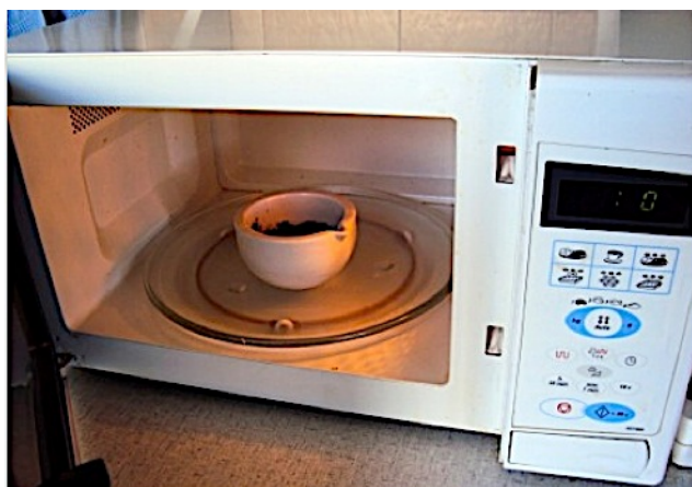
5.7. kép. A lebegtetett hordalék-minta szárítása és tömegének mérése (fotók: Makádi M. 2013)
