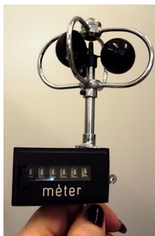
4.4. kép. A kézi kanalas szélmérő (fotó: Makádi M. 2013)
