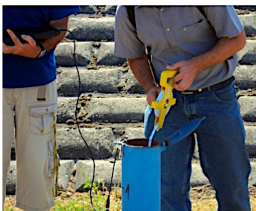
5.2. kép. Talajvízszintmérés mérőkútban és a talajvízhőmérő leolvasása (fotók: 2012)
