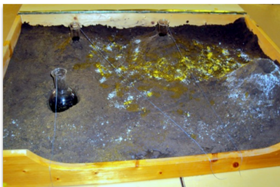
6.22. kép. Reakciótér homokba süllyesztett lombikkal utóvulkáni jelenségek modellezésekor (fotó: Makádi M. 2011)
