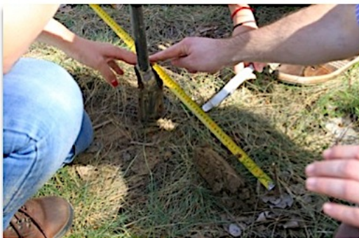
2.9. kép. A talajfűrővel vett minta mérése (fotó: Vigh-Tarsonyi G. 2012)
