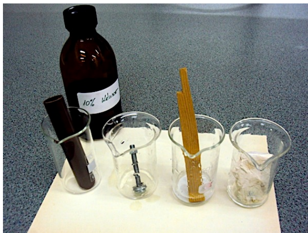
4.14. kép. Anyagminták kénsavas oldattal való reakciójának vizsgálata (fotó: Makádi M. 2013)
