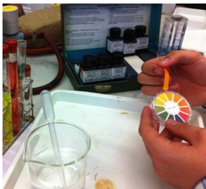
5.8. kép. Vízminták kémhatásának meghatározása indikátorpapírral (fotó: Farkas B. P. 2013)
