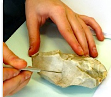
3.1. kép. Karpróba kalciton körömmel (balra) és szarukövön tűvel (jobbra) (fotók: Makádi M. 2013)
