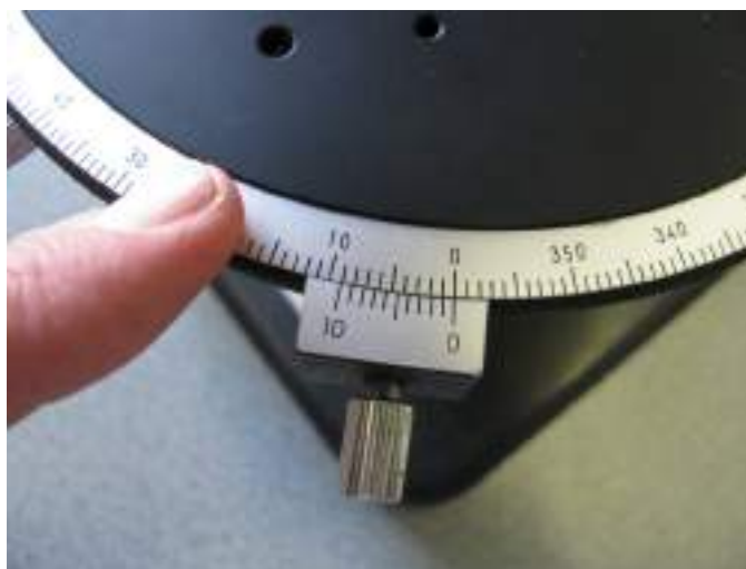
III.42. ábra – Polarizációs kőzettani mikroszkóp fokbeosztással ellátott forgatható tárgyasztala.
