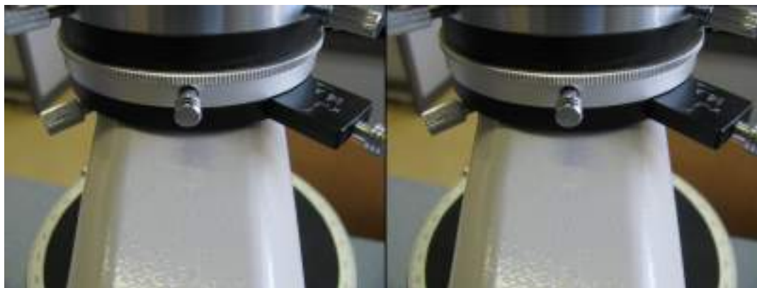
III.43. ábra – Polarizációs kőzettani mikroszkóp analizátora kihúzott (egy nikolos vizsgálat) és betolt (keresztezett nikolos vizsgálat) helyzetben.
