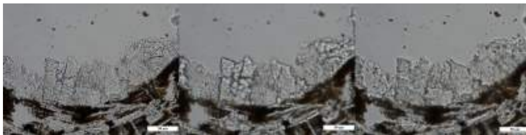
III.88. ábra – Becke-vonal vizsgálata kalcit és kanadabalzsam határán. A bal kép éles, míg a középsőn növeltük, a jobb képen csökkentettük a tárgyasztal és az objektívek közti távolságot. Ennek megfelelően előbb a nagyobb törésmutatójú közegben, a kalcitban jelent meg egy világos sáv (középső kép), majd a kanadabalzsamban (jobb kép). Mindegyik kép 1N.
