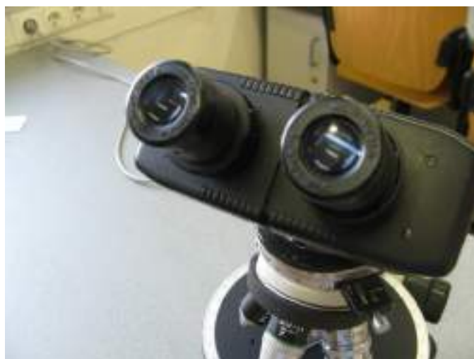
III.47. ábra – Polarizációs kőzettani mikroszkóp binokuláris okulárja. Az okulár széthúzásával állítható a megfelelő szemtávolság, az egyik okulár forgatásával pedig a szemnek megfelelő élesség.
