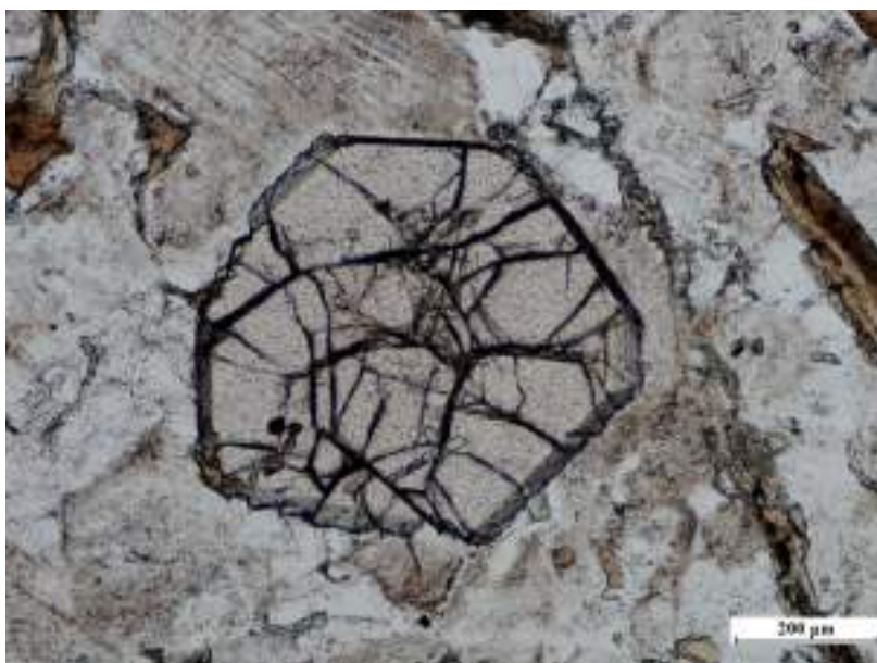
III.59. animáció: A nikolok keresztezésének hatása tonalitban lévő gránátkristály esetében (Szarvaskő). Kattintásra lehet egyik képből a másikba átmenni.
