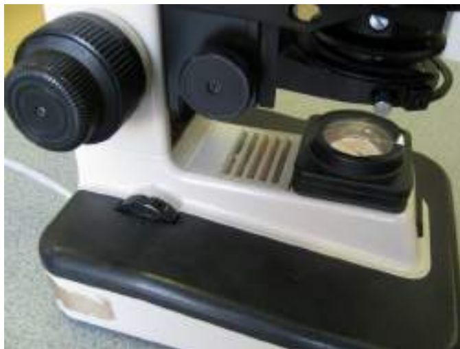
III.41. ábra – Polarizációs kőzettani mikroszkóp alsó, kék szűrővel ellátott megvilágító egysége.
