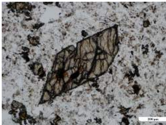
III.67.animáció: A nikolok keresztezésének hatása titanit kristály esetében. Kattintásra lehet egyik képből a másikba átmenni.
