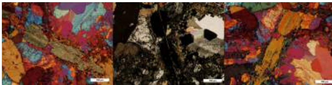
III.103. ábra – Amfibol (andezitben, Sátorosi-kőfejtő) főzónajellegének meghatározása (I.). A bal képen szubtrakciót, a jobb képen addíciót tapasztalunk a gipszlemez beiktatása után a maximális interferenciaszínhez képest (III.97./C kép). A segédlemez törésmutatóinak irányával összevetve megállapítható, hogy pozitív főzónajellegű az ásvány.
