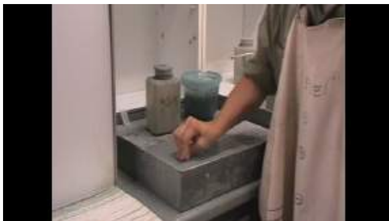
III.28. videó: Végül a '800'as por következik. A vizsgált minta egyik oldalának csiszolását itt befejezzük. A képre kattintva erről tekinthető meg videofelvétel.
