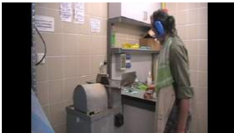
III.20. videó: A képre kattintva egy videofelvételen mutatjuk be, hogyan vágjunk le csiszolat méretű darabot a vizsgálandó kőzetből.
