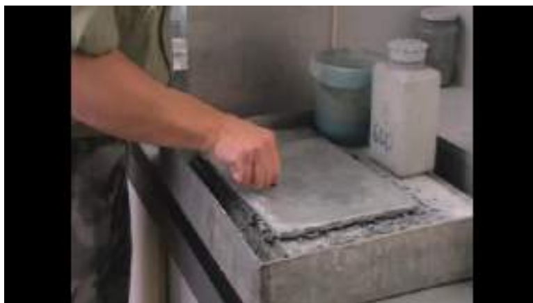
III.36. videó: Tovább koptatjuk a mintát kézi csiszolással, a '600'-as poron kezdünk. A képre kattintva erről tekinthető meg videofelvétel.
