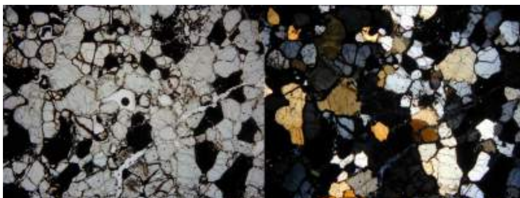
V.11. ábra – Gránát-piroxenit (websterit) kőzetárvány mikroszkópos képe (a kép alsó hossza 2,5 mm). A gránátok elbomlottak (sötét, izotróp ásványegyüttes) és csak alakjuk után ismerhetők fel. Lelőhely: Waw an Namus maar, Líbia
