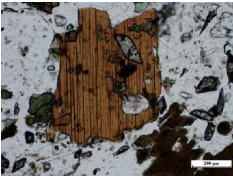
III.2. animáció: Erős pleokroizmus: biotit (foidolitban, Günsehals) Kattintásra lehet egyik képből a másikba átmenni
