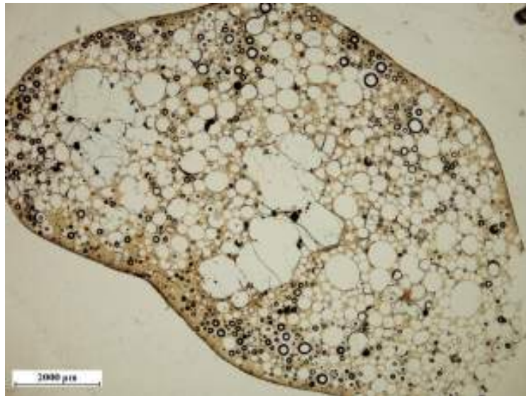
III.321. ábra – Pele-könnye mikroszkópos képen (egy nikolos felvétel). Figyeljük a sárgásbarna szideromelán alapanyagot és az olivin fenokristályok mellett megjelenő kerekded gázbuborék üregeket.
