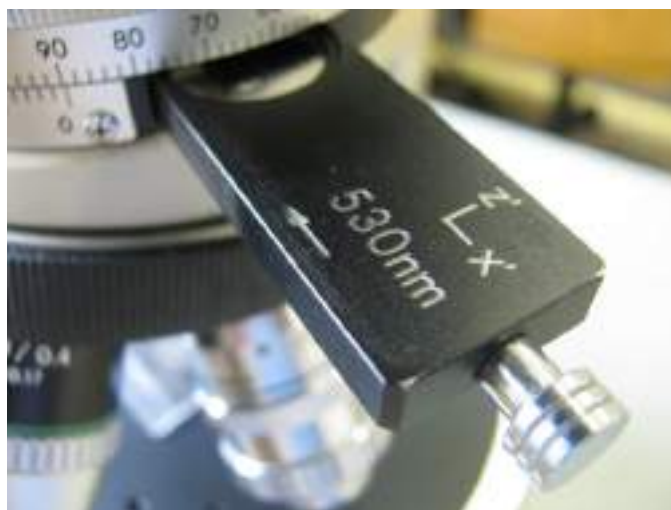
III.49. ábra – Polarizációs kőzettani mikroszkóp felső részén, diagonális helyzetben található segédlemez..
