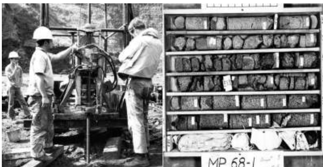
II.79. ábra – A Makaopuhi lávató fúrása és a kőzetminták. Forrás: USGS Professional Paper 1004 (1977)
