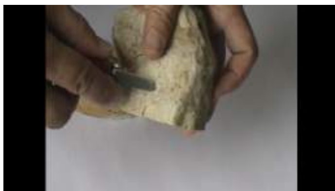
III.7. videó: A képre kattintva egy videofelvételen mutatjuk be a kőzetek karcpróbáját késsel.
