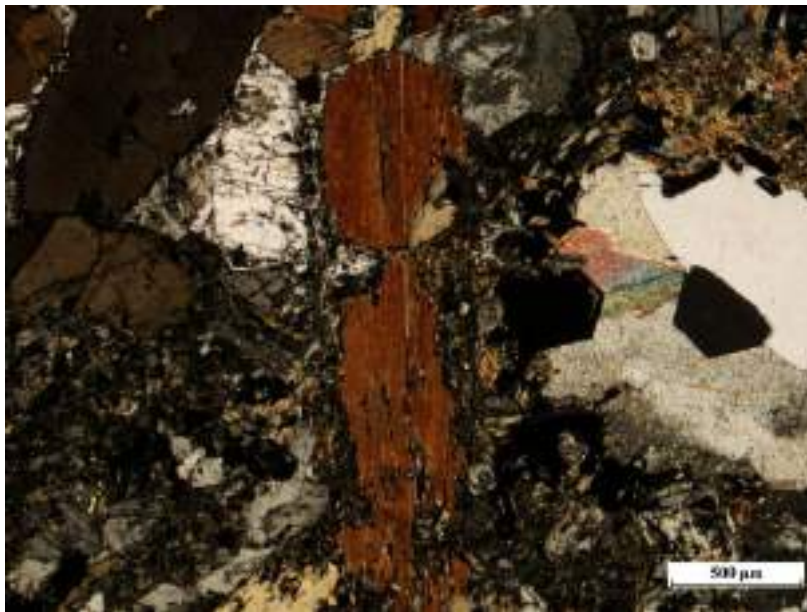
III.9.animáció: Kioltási szög mérése amfibolon (andezitben, Sátorosi-kőfejtő). A mért kioltási szög a \gamma/c : 14^\circ . Kattintásra lehet egyik képből a másikba átmenni.
