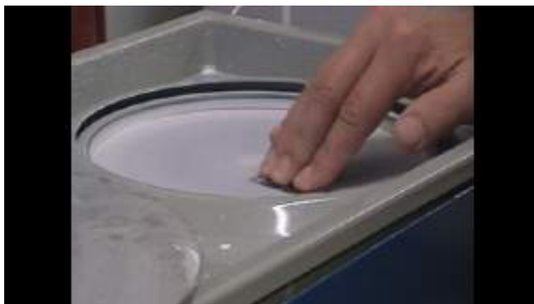
III.40. videó: A mintát igen finom gyémántpasztán tökéletesen simára polírozzuk. A képre kattintva erről tekinthető meg videofelvétel.
