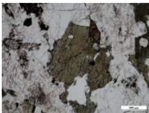
III.189. ábra – A hornblende pleokroizmusa, színének változása a tárgyasztal körbeforgatásával (szienitben). Fotók: egy nikollal.
