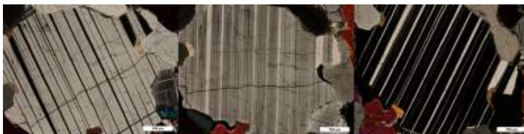
III.107. ábra – Plagioklász (gabbróban) szimmetrikus zónában vett kioltásának meghatározása. Először az ikerlemezek megnyúlási helyzetének megfelelően függőleges helyzetbe állítjuk az ásványt (középső kép). Ezután balra forgatjuk a tárgyasztalt, amíg az iker minden második tagja, melyek egyforma orientációjúak, kioltási helyzetbe nem kerülnek (bal kép), majd leolvassuk a tárgyasztalon kapott fokértéket. Ezután ellentétes irányba forgatjuk a tárgyasztal, amíg azt nem tapasztaljuk, hogy a többi ikertag olt ki (jobb kép). Most is leolvassuk a tárgyasztal nóniuszkálája segítségével az adott helyzetnek megfelelő fokértéket. Ha a két érték különbsége 5^\circ -on belül van, akkor az átlaguk lesz a szimmetrikus zónában vett kioltás, ami függ a plagioklász összetételétől, így annak meghatározására használható. Példánkban mintegy 30^\circ -nak adódik, ami labradoritos összetételt jelent. Mindegyik kép +N.
