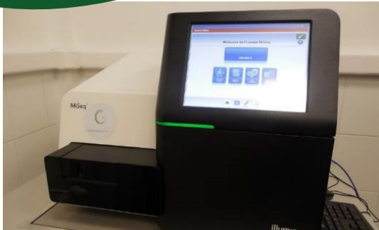
Illumina MiSeq NGS készülék a DNS szekvenáláshoz. Illumina MiSeq NGS equipment for DNA sequencing.
